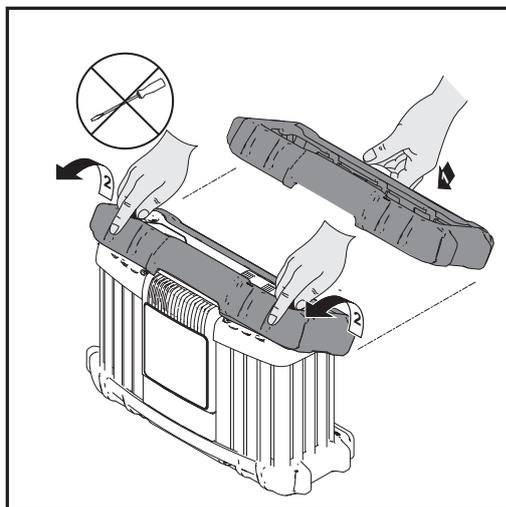
Die Demontage des Kantenschutzes erfolgt in umgekehrter Reihenfolge der Montage.
