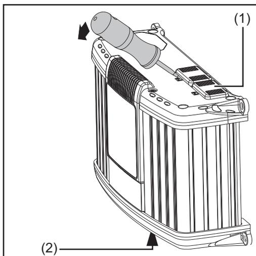
Falls erforderlich, mittels Schraubendreher entfernen:
