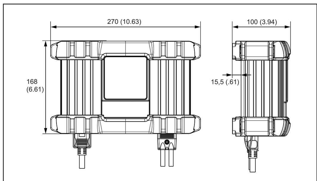
Platzbedarf mit Kantenschutz (\* Freiraum für Montage / Demontage)
